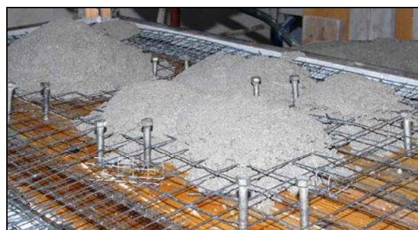
Slika 7. Izrada stropnih konstrukcija modela: a) bijeli strop modela M1 (gore) i b) jedna od ploča modela M2 (dolje)
